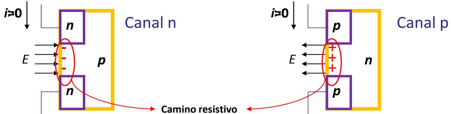
**Transistor unipolar**  $\Rightarrow$  corriente debida a un solo tipo de portadores (electrones o huecos)
